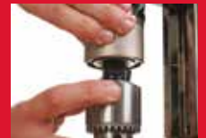
19mm weldon bağlantısı
